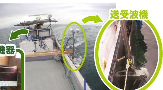
システムの送受波機は船体に取付けられ、小型船舶でも十分に使用できます。船上に設置される機器はパソコン 3 台分程度の大きさなので場所も取りません。
